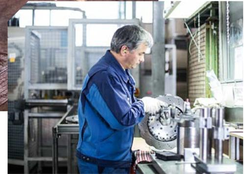
Seit 1994 stellen wir Verbundbrems Scheiben her und sind in diesem Segment Marktführer. Die SHW Verbundbrems Scheiben bestehen aus dem Reibring aus Gusseisen und dem Topf aus dem Leichtmetall Aluminium, verbunden durch Stahlstifte. Durch den Einsatz von Aluminium kann das Fahrzeuggewicht um bis zu 8 kg reduziert werden – ein wichtiger Beitrag zur CO<sub>2</sub>-Reduktion. Die SHW-Verbundbrems Scheiben erfahren stetig steigende Nachfrage.
