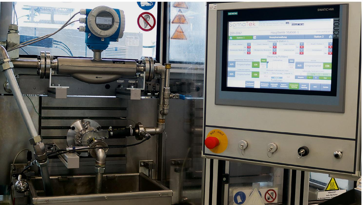
BILD 5 Versuchsaufbau zur Vermessung der Pumpen am Prüfstand (© SHW Automotive)
