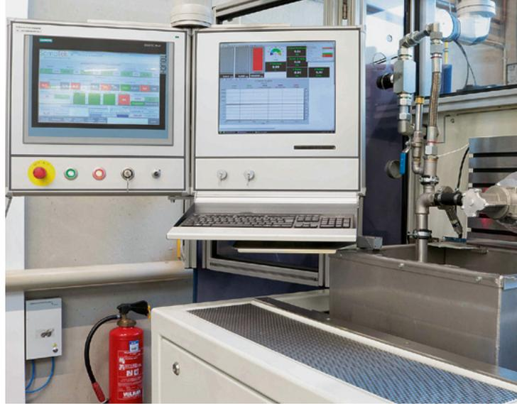
**BILD 1** Versuchsaufbau zur Vermessung der Pumpen am Ölpumpenprüfstand (© SHW)
