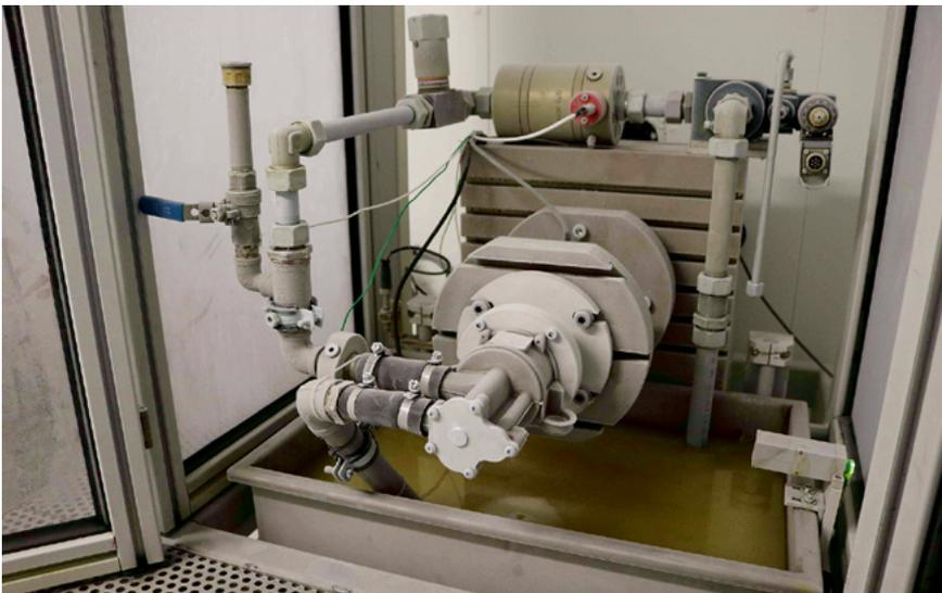
BILD 4 Versuchsaufbau zur Messung der Anlaufdrehmomente der Pumpen in der Kältekammer bei -30 °C (© SHW)
